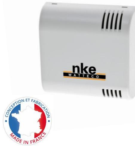
Le capteur mesure la température et l'humidité relative ambiante en intérieur. La transmission des données sur réseau public ou privé LoRaWAN® se fait périodiquement ou immédiatement en cas d'alerte :
